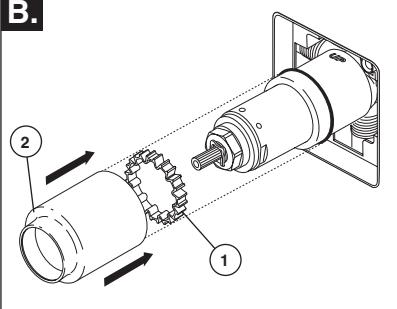
Si le modèle que vous installez nécessite une pièce d'espacement (1), introduisez-la dans le manchon (2). Faites glisser le manchon sur la cartouche, le corps et le joint torique. Assurez la couverture d'équilibre est correctement placé au-dessus de l'avant de la cartouche de douche. **Note :** les modèles RSVP<sup>MC</sup> (série T60X90) n'exigent pas de pièce d'espacement (1).
