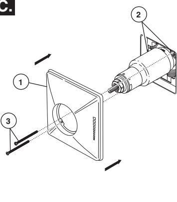
Fije la roseta con orificio (1) al soporte (2) usando los 2 tornillos suministrados (3). No apriete demasiado los tornillos de la roseta.
