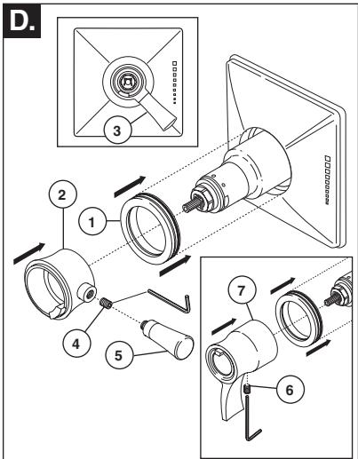
Glissez l'excédent de l'anneau d'équilibre (1) la cartouche et la douille et dans le cache. Installez la base de poignée de commande de volume (2) avec la poignée de levier vers la droite en tant que (3) montré. Installez la vis de réglage (4) suivie du levier de poignée (5).
