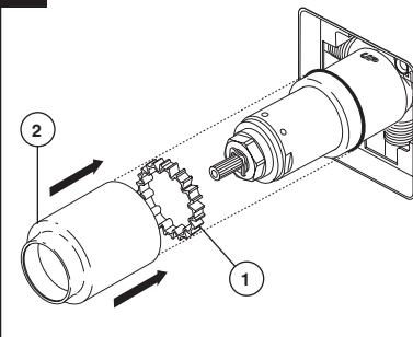
Si su modelo requiere un separador (1), insértele en la manga (2). Deslice la manga sobre el cartucho, el cuerpo de la pieza y el aro O. Asegure la cubierta de ajuste se coloca correctamente sobre el frente del cartucho de la ducha. **Nota:** Los modelos RSVP™ (series T60X90) no requieren un separador (1).
