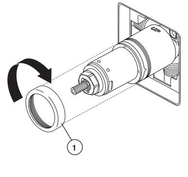
Faites glisser l'écrou à portée sphérique (1) sur la cartouche et vissez-le sur le corps. Serrez à la main fermement.
