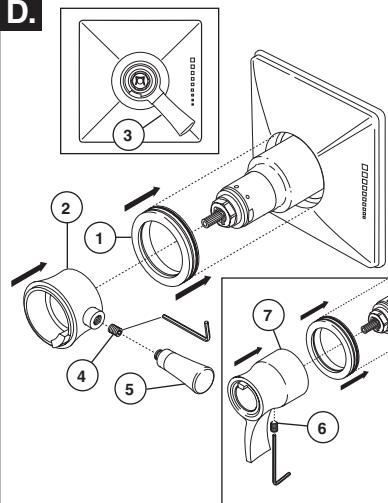
Resbale el excedente del anillo del ajuste (1) el cartucho y la manga y dentro del escudo. Instale la base de la manija de control de volumen (2) con la maneta palanca a la derecha como (3) demostrado. Instale el tornillo de presión (4) seguido por la palanca de la manija (5).
