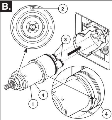
Tournez la cartouche (1) de sorte que le mot « UP » (2) se trouve sur le dessus. Introduisez la cartouche dans le corps de la soupape comme le montre la figure. Assurez-vous que les tubes et les joints toriques (3) sont bien calés dans les orifices à la base du corps. Assurez-vous que les ergots sont parfaitement engagés dans les rainures du corps (4).
