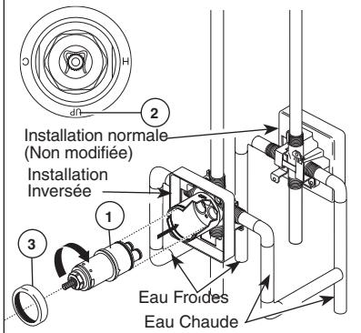
Dans le cas d'une installation dos à dos ou inversée (eau chaude à droite et eau froide à gauche) : Tournez la cartouche (1) de sorte que le mot « UP » (2) se trouve sur le dessus. Installez la cartouche en vous assurant que les ergots sont introduits entièrement dans les rainures du corps de laiton (reportez-vous à l'étape B). Faites glisser l'écrou à portée sphérique (3) sur la cartouche et vissez-le sur le corps. Serrez à la main fermement.
