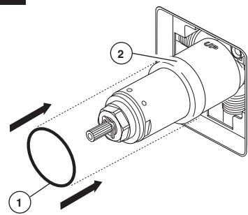
Deslice el aro O (1) sobre el cartucho y la tuerca tapa (2). El aro O, el cual funciona como un separador para estabilizar la manga, debe quedar apoyado en la tuerca tapa.
