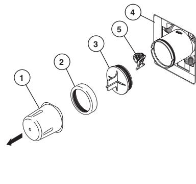
**Interrompez l'arrivée d'eau.** Enlevez le couvercle (1), l'écrou à portée sphérique (2) et le capuchon d'essai (3) du corps. Si vous n'installez pas l'appareil dans une paroi mince, vous pouvez retirer le protecteur (4) complètement. Si l'écran (5) est en place, enlevez avant d'installer la cartouche.
