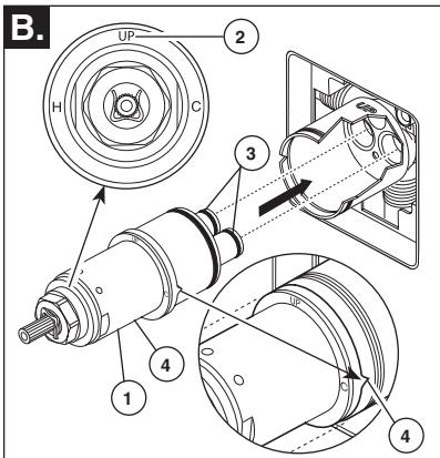
Gire el cartucho (1) de manera que la palabra "UP" (2) aparezca encima. Introduzca el cartucho en el cuerpo de la válvula como se muestra. Asegúrese que los tubos del cartucho y los aros O (3) estén debidamente sentados en los agujeros en la base del cuerpo. Asegúrese que los dentados estén completamente enganchados en las muescas del cuerpo (4).
