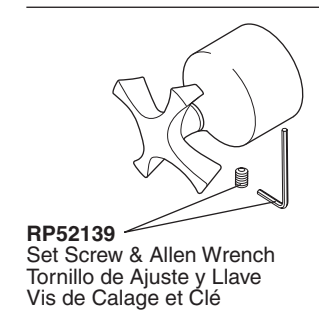
RP52139 Set Screw & Allen Wrench Tornillo de Ajuste y Llave Vis de Calage et Clé
