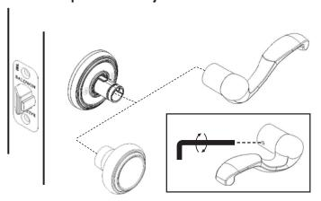
Coloque el pomo o manija sobre el ensamblaje y ajuste el tornillo para asegurar. Repita para el pomo o manija por el otro lado.
