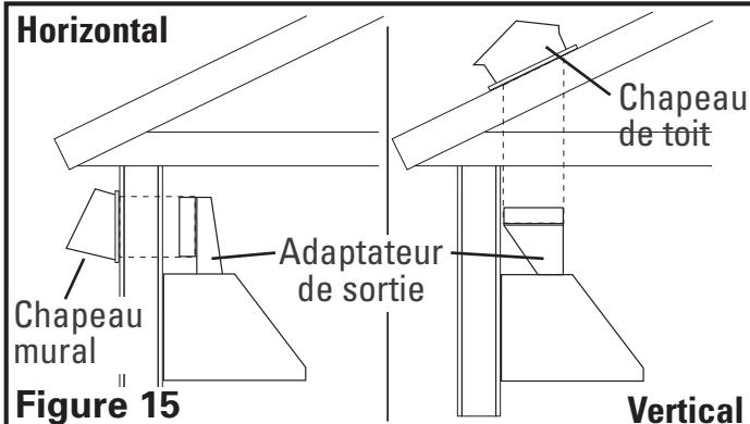
8. Installez l'adaptateur mural de la bonne taille requise (disponible séparément) à la hotte en le glissant dans les quatre trous percés précédemment sur la bride de l'adaptateur appariés aux quatre trous correspondants sur la hotte et fixez en place avec les vis comprises. Assurez-vous que le joint est étanche autour de l'adaptateur en sécurisant tous les raccords avec du ruban de gaine (**Figure 16**).
