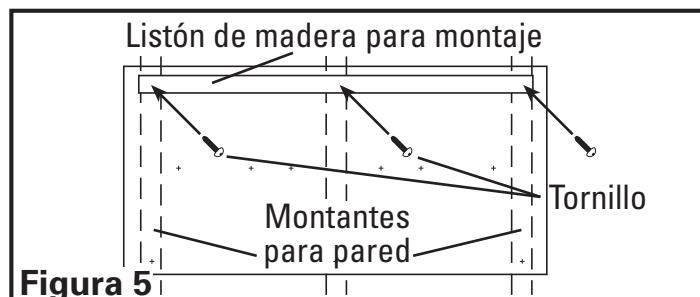
**PRECAUCIÓN:** DEBIDO AL PESO DE LA CAMPANA, ASEGÚRESE QUE EL LISTÓN DE MADERA ESTÉ SUJETADO A TODOS LOS MONTANTES PARA PARED DISPONIBLES (UN MÍNIMO DE 2 MONTANTES PARA CAMPANAS DE 762 mm, Y MÁS CANTIDAD A MEDIDA QUE EL ANCHO SE INCREMENTE) NO SOLAMENTE AL PANEL DE YESO.
