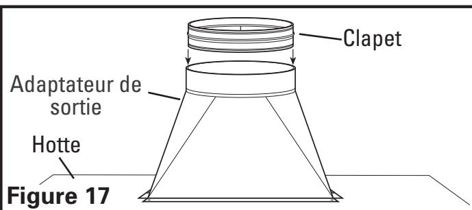
10. Raccordez les conduits à l'adaptateur de sortie et du clapet. Fixez en place en utilisant du ruban de gaine pour sceller tous les joints (**Figure 18**).
