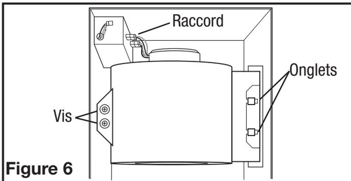
**REMARQUE :** Si le raccord du moteur de ventilateur est raccordé au réceptacle du châssis, le débrancher afin que l'assemblage de la soufflante soit complètement enlevé.
