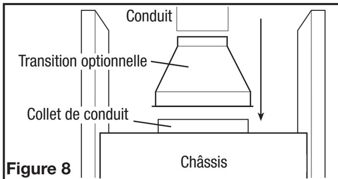
**REMARQUE :** Pour effectuer la transition aux conduits circulaires, Air King recommande l'utilisation du modèle OA10H 4 1/2 po x 18 po à 10 po transition circulaire (non inclus). Lorsque vous utilisez le modèle OA10H, le collier de conduit existant doit être retiré.
